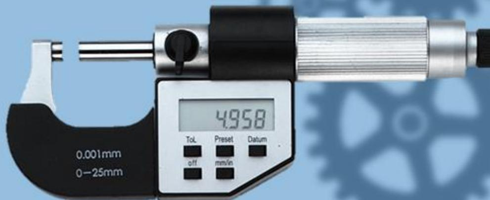
La struttura del micrometro digitale è la stessa di quello analogico per esterni, ma in questo tipo di micrometri sul corpo viene montato un indicatore elettronico digitale che rileva lo spostamento dell'asta di misurazione.
